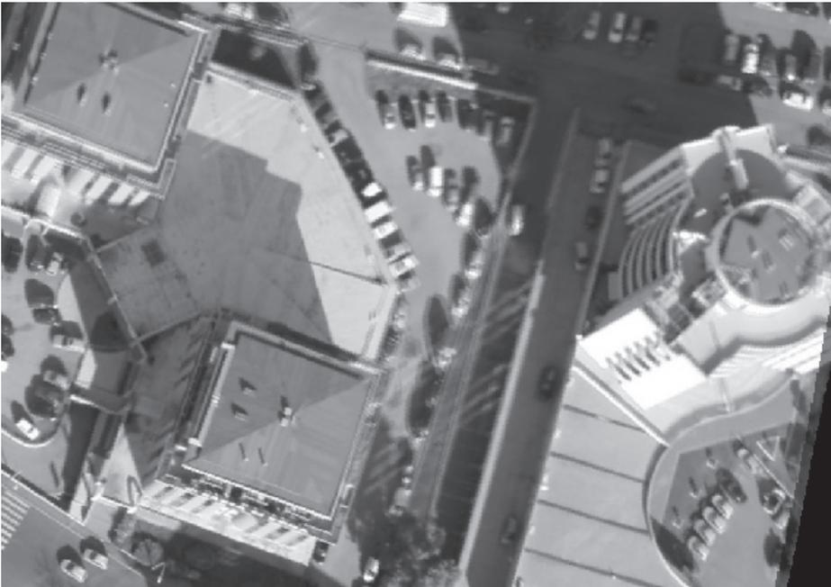
*Fig.1: Ingrandimento di un'area visualizzata in semitrasparenza su 3 ortofoto sovrapposte (ottenute con i 3 software citati nel testo) per mettere in evidenza le differenze geometriche. Come si vede, l'errore di calcolo è dell'ordine di qualche pixel, non costante sulla superficie dell'immagine. Nell'angolo basso a sinistra dell'area ingrandita non si vedono differenze significative, mentre nella parte centrale si trovano spostamenti visibili.*
