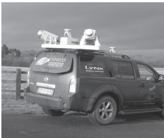
Figura 1: Sistema Lynx montato su un camioncino.
