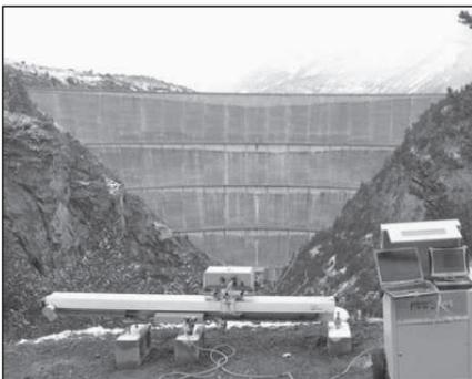
Fig. 1. *IBIS-L* posizionato di fronte al paramento di valle della diga di Cancano
