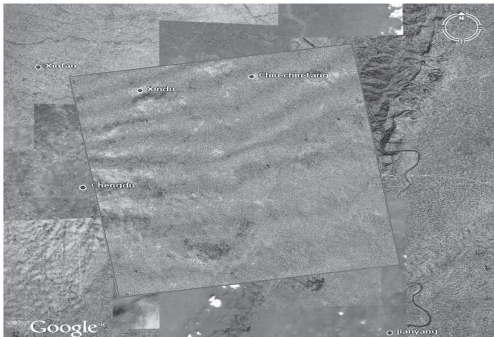
*Figura 5. Interferogramma cosismico geocodificato nell'area a oriente di Chengdu ottenuto dai dati in banda X acquisiti dal satellite dell'ASI Cosmo SkyMed. Si distinguono chiaramente le frange dovute allo spostamento con una coerenza notevole persino in aree vegetate.*
