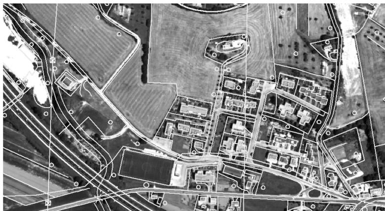
Figura 3 Ortoimmagine RGB ottenuta col software SOCET Set con superimposta la CTR
