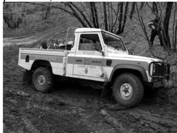
Figura 3 - Uno dei due Land Rover 110 sul quale è montato uno dei moduli antincendio
