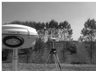
Ricevitore Trimble R6 – radio trasmittente/ricevente integrata
