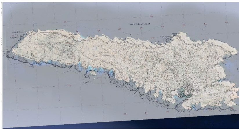
Fig. 4. Esempio di scostamento in questo caso fra datum ED50 e WGS 84
