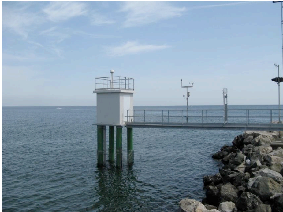
Fig.3. Porto Garibaldi (Comacchio): stazione mareografica integrata con GNSS permanente
