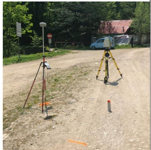
Fig.2.2.2.2 Scanner C10 in stazione di scansione e rover GPS Trimble R8s stazionato sul punto n.2
