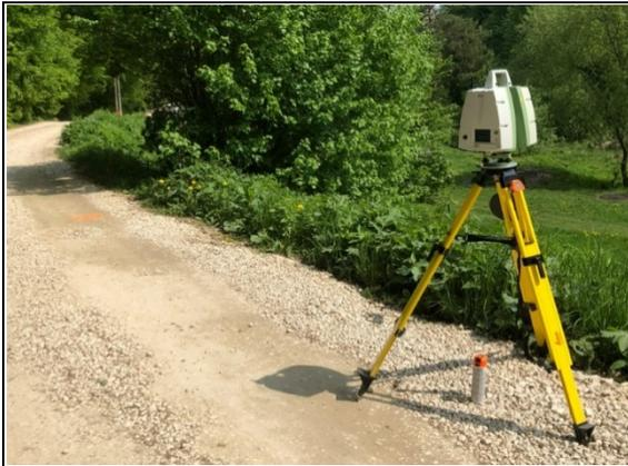
Fig.2.2.2.1 Scanner C10 in stazione di scansione su allineamento drm
