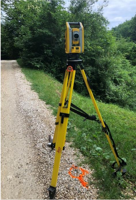
Fig.2.2.3.1 Stazione totale robotizzata Trimble S5
