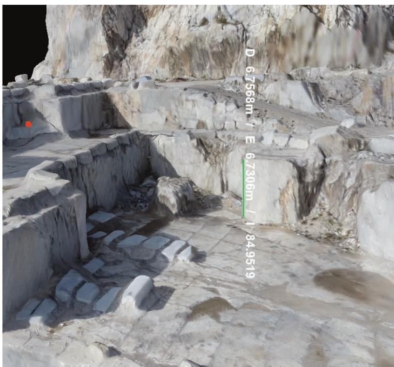
Figura 10 - Calcolo 3D in ambiente 3D Zephyr Aerial (piazzale di cava e altezza delle bancate)
