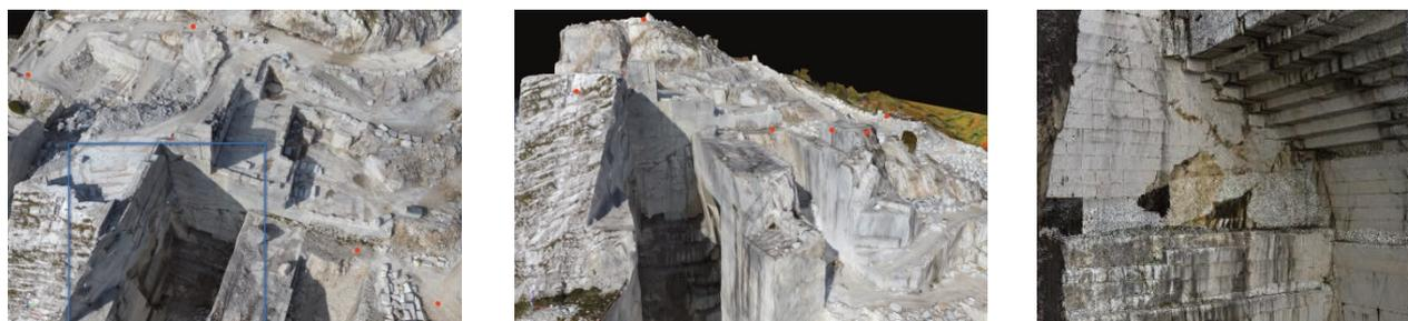
*Figura 5 – Cava n. 4: a sinistra e al centro: dettaglio zona con assenza di segnale GPS (canyon), mesh da rilievo SAPR. A destra: area con parete in aggetto (mesh da rilievo da terra)*
