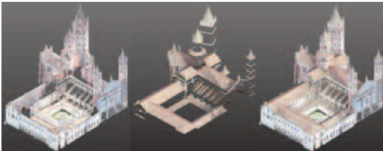
Figura 3 – Processo di costruzione della nuvola integrale.
