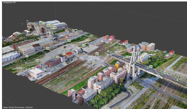
Figura 2 - modello 3D creato con 1039 immagini del 22 Agosto 2018, georeferenziato con 28 punti a terra (errore medio 4 [cm])
