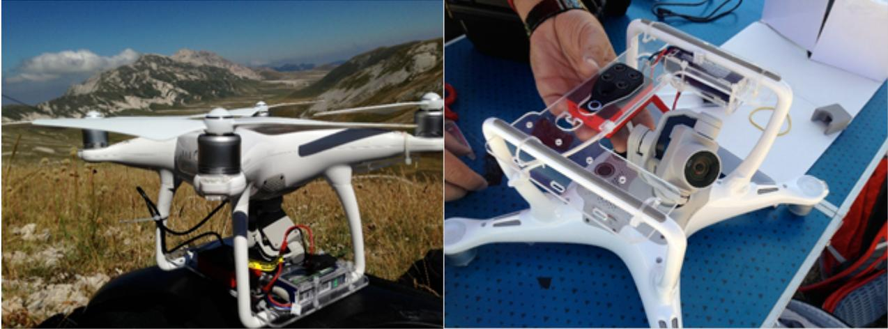
Figura 1 - Drone equipaggiato con camera multispettrale
