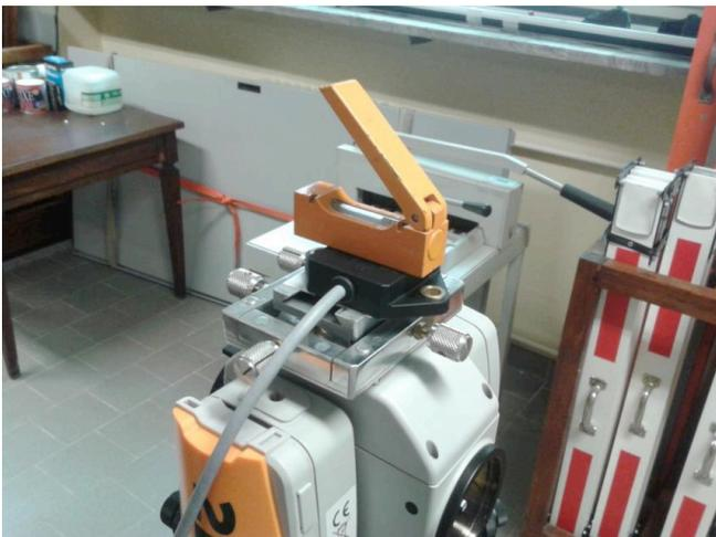
Figura 4: verifica dell'accuratezza dell'inclinometro 4030
