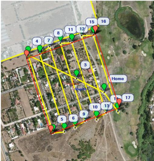
Le immagini provenienti dal volo nadirale sono state elaborate dai software commerciali Agisoft Photoscan e Pix4D. Per entrambi i software l'obiettivo era quello di ottenere un modello 3D georeferenziato dell'area test, nel sistema ETRF2000.
