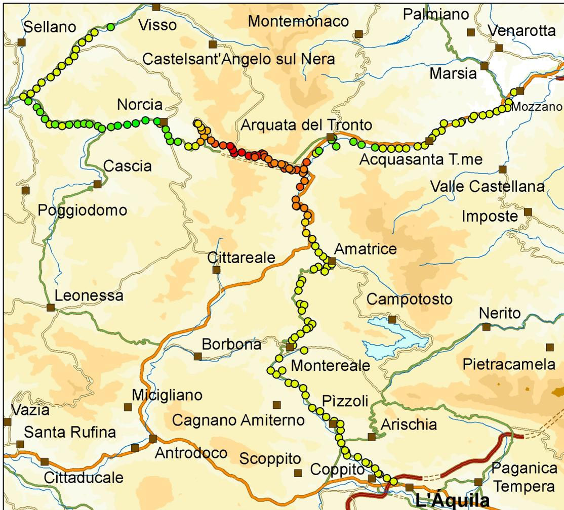
Figura 4 – Movimenti dei caposaldi della parte rimisurata della linea n. 124
