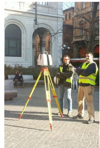
Figura 5 - TLS durante le fasi del rilievo
