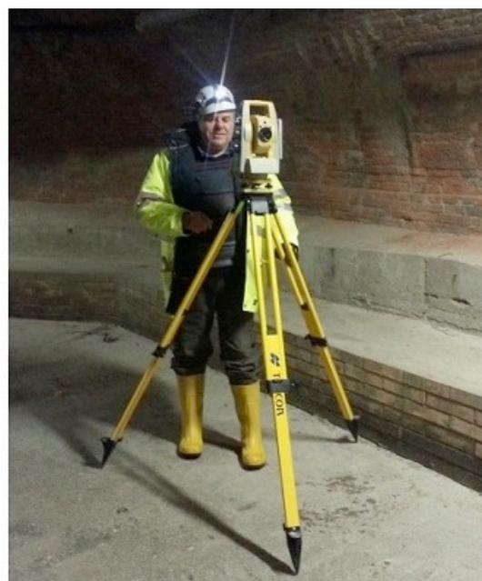
*Figura 3 – Operazioni di poligonazione di superficie e in sotterranea*
