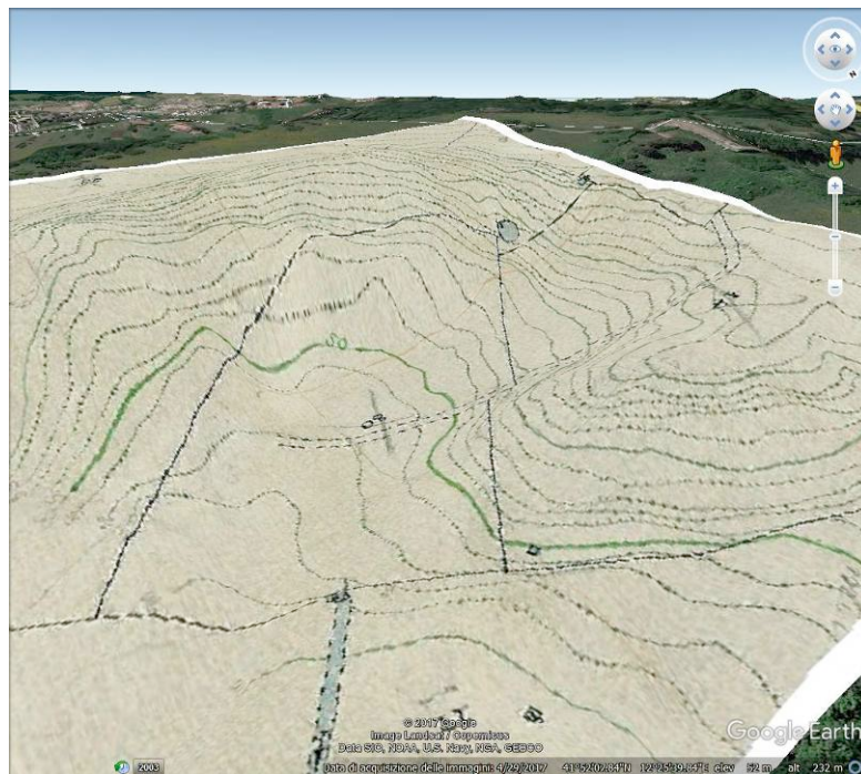
Figura 7 – Mappa d'impianto raster completa dell'informazione altimetrica, sovrapposta al DEM di Google Earth per il confronto fra i due dati altimetrici
