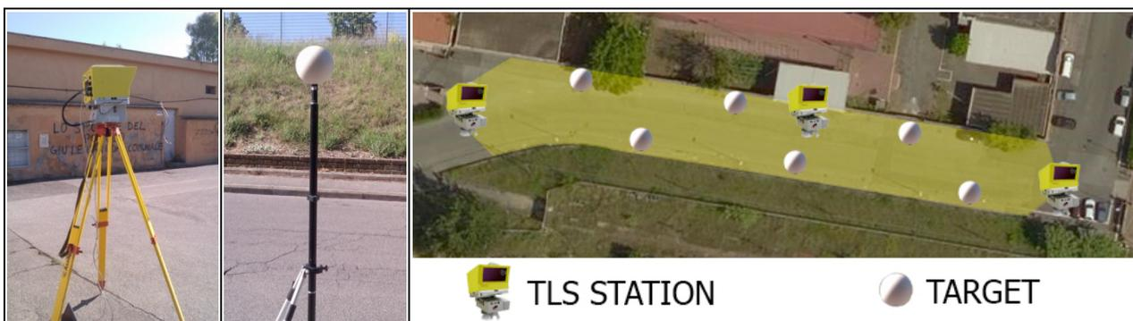
Figura 2 - Stazione TLS, target e disposizione stazioni e target
