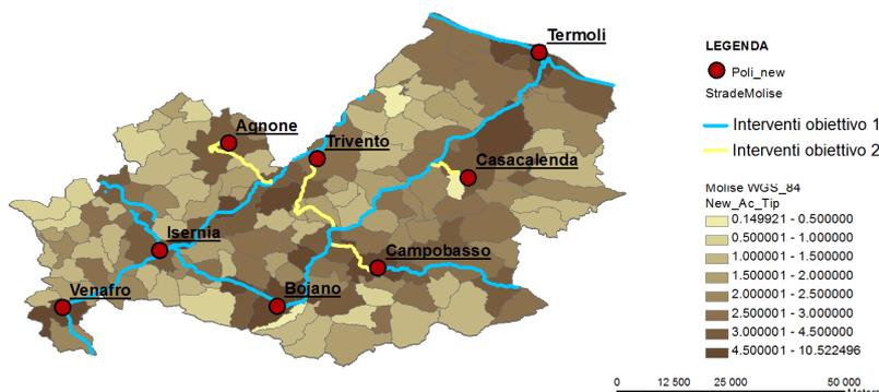
Figura 9 - Nuova accessibilità topologica ponderata con indicazione delle strade da potenziare
