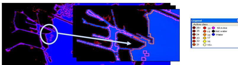
Figura 6 – Immagine segmentata e classificata e particolare della linea a 50 m dalla costa analizzata.
